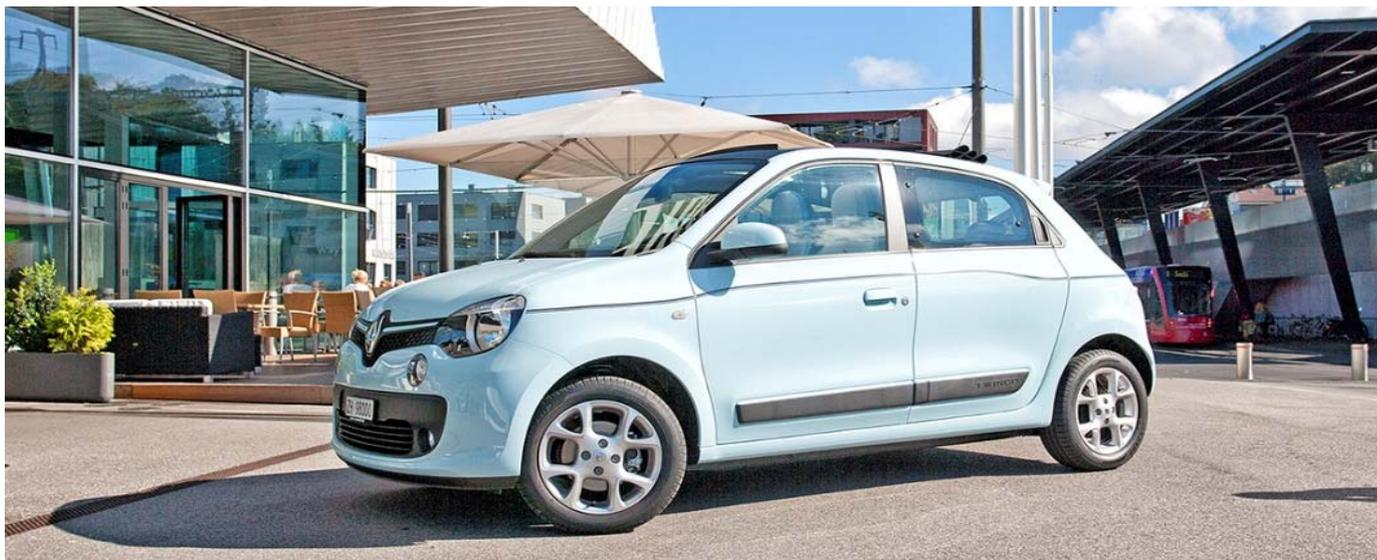
DER RENAULT TWINGO ZEIGT SICH IN SEINER DRITTEN GENERATION VON 2014 WIEDER VON DER FRECHEN SEITE. MIT DEM NEU IM HECK ANGEORDNETEN MOTOR MIT HECKANTRIEB TEILT ER SICH DIE PLATTFORM MIT DEM NEUEN SMART FORFOUR. DER KLEINE STADTFLITZER MUSS SICH IM TCS-TEST ALS 70 PS BENZINER IN DER AUSSTATTUNGSLINIE INTENS BEWEISEN.
